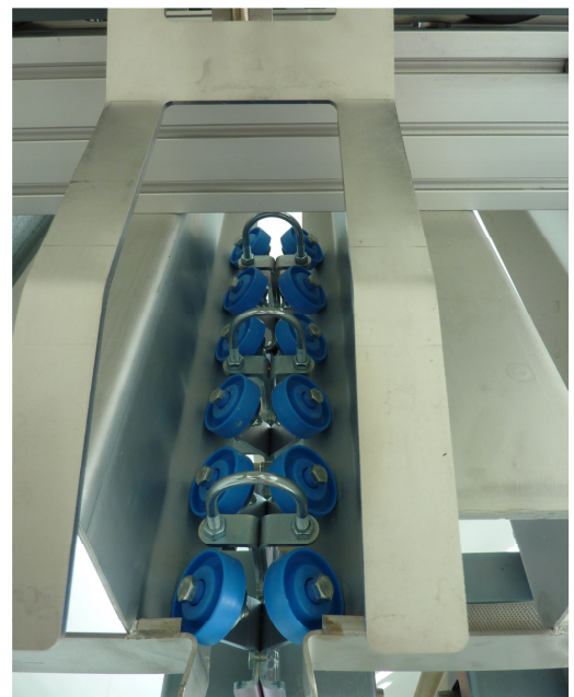
Vier kugelgelagerte Laufrollen ermöglichen eine optimale, verdrehsichere Führung der Adapter in den Schlauchbahnen
