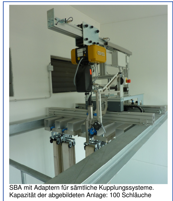
SBA mit mechanischem Schlauchgreifer für sicheren Betrieb
