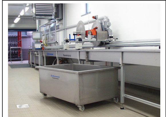
( Sonderentsorgungsbehälter oder Prüfwasserrückgewinnungsbehälter n fahrbarer Ausführung aus Edelstahl für ca. 500 ltr Inhalt )
