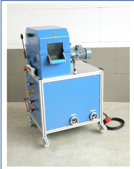
Fahrbares Schlauchpflege-Kompaktgerät zum Waschen und Prüfen von Feuerwehrschläuchen der Größe D-C-B bestehend aus:
