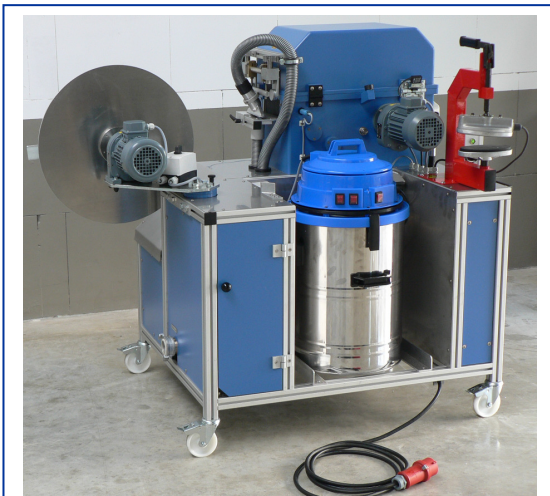
( Wickler in schwenkbarer Ausführung für gleichzeitigem Wasch-Wickelbetrieb oder seitlich neben das SPZ geschwenkt zum einfach oder hälftigem Wickeln der Schläuche. Bedienung über Fußtastschalter.)
