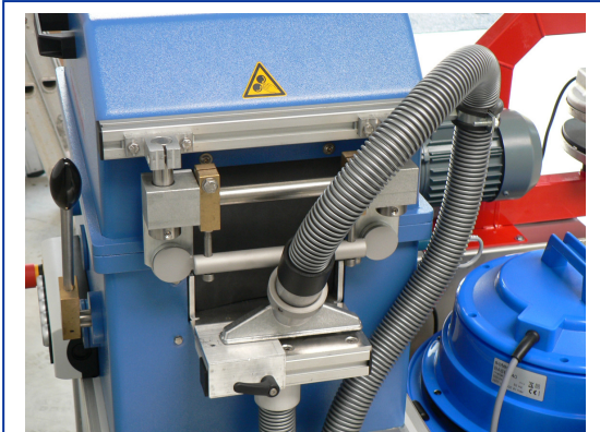
( Schwenkbare Wasserabsaugvorrichtung zur Schlauchtrocknung )
