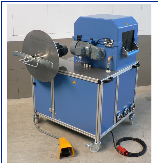
( Wickler seitlich neben das SPZ geschwenkt zum einfach oder hälftigem Wickeln der Schläuche. Bedienung über Fußtastschalter.)
