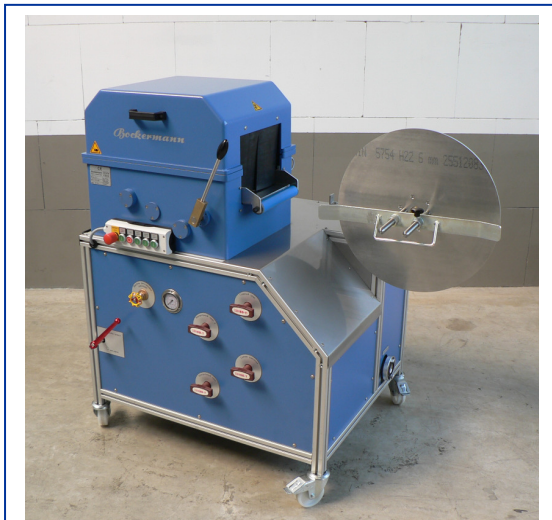
( Wickler in schwenkbarer Ausführung hier für gleichzeitigem Wasch-Wickelbetrieb. )
