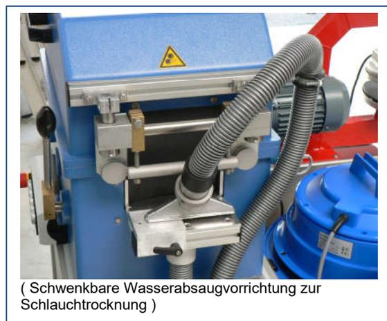
( Schwenkbare Wasserabsaugvorrichtung zur Schlauchtrocknung )
