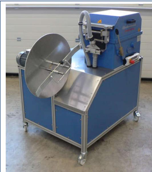
(Wickler in schwenkbarer Ausführung für gleichzeitigen Wasch-Wickelbetrieb)
