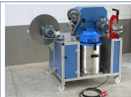
(Wickler seitlich neben das SPZ geschwenkt zum einfach oder häufigem Wickeln der Schläuche. Bedienung über Fußtastenschalter)
