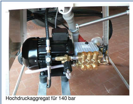
Hochdruckaggregat für 140 bar
