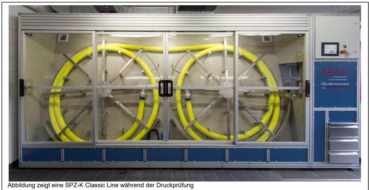
Abbildung zeigt eine SPZ-K Classic Line während der Druckprüfung
