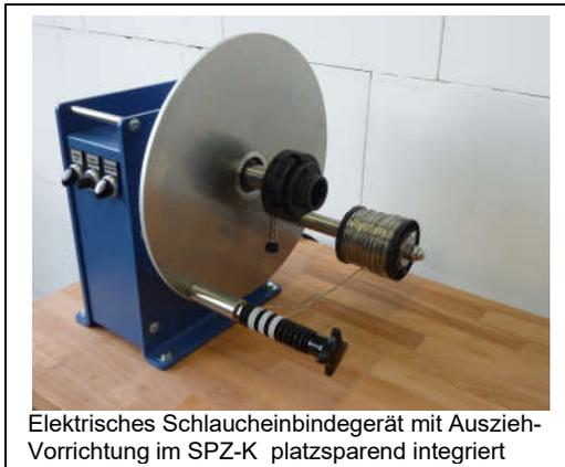
Elektrisches Schlaucheinbindegerät mit Ausziehvorrichtung im SPZ-K platzsparend integriert
