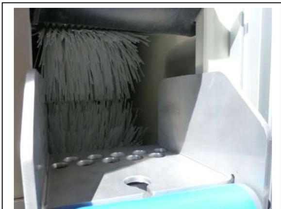
Bürsten Hochdruck-Schlauchwaschmaschine mit automatischem Schlaucheinzug.
