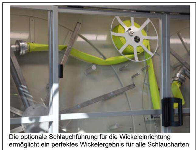
Die optionale Schlauchführung für die Wickleinrichtung ermöglicht ein perfektes Wickelergebnis für alle Schlaucharten
