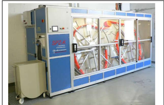
**Vorbildlich:** Vollautomatisches Wickeln mit Entwässern des Schlauches im Anschluss an die Druckprüfung. Optimaler Personenschutz durch die Sicherheitsscheiben.
