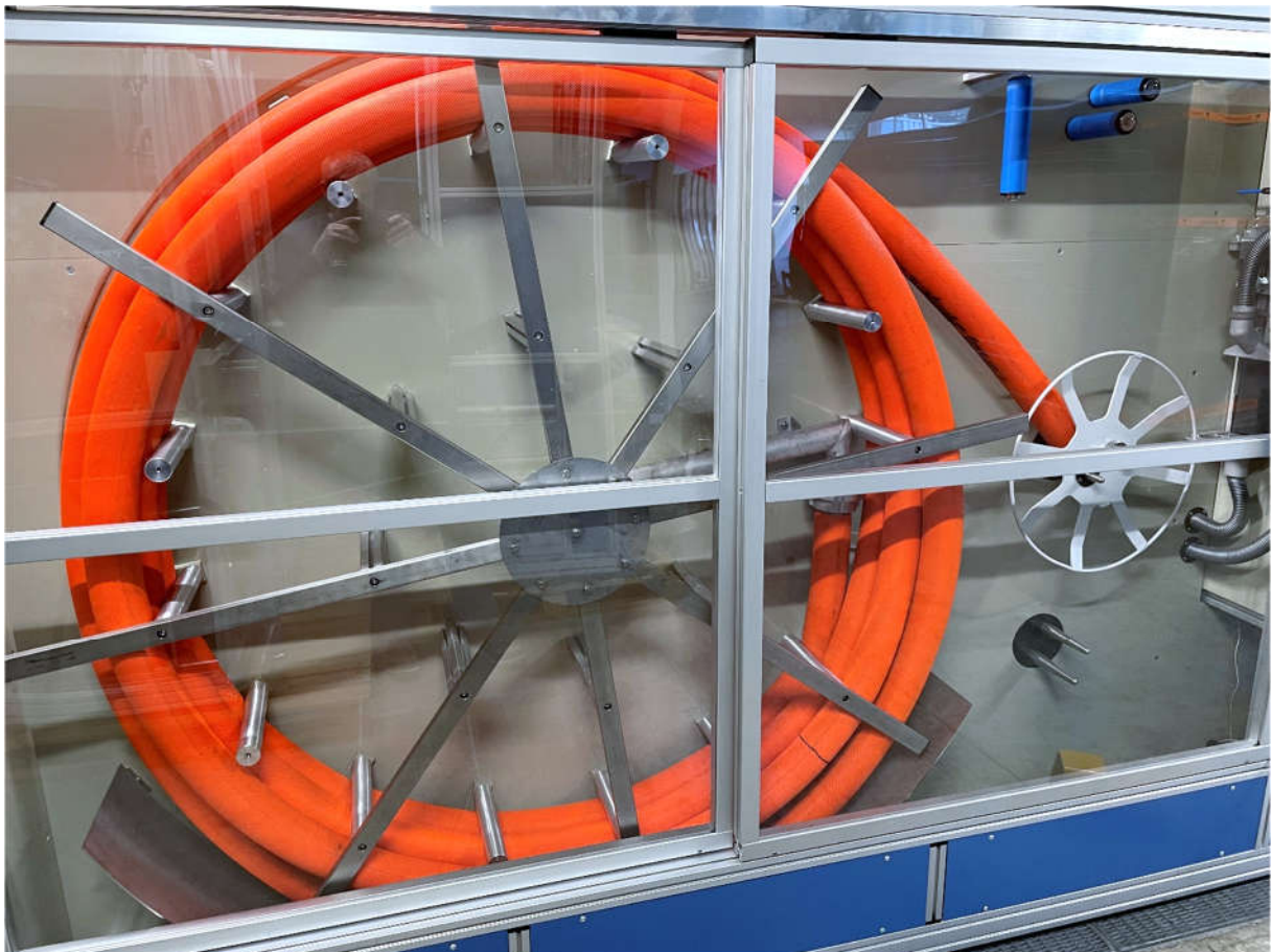
Abbildung zeigt ein TechLine...Schlauchpflegesystem während der Druckprüfung
