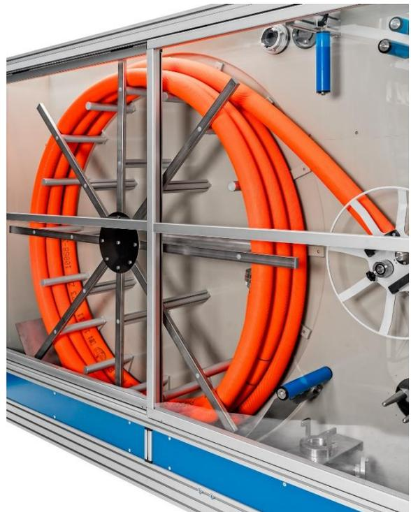
Mit der Anlage werden Prüfdrücke bis 16 bar nach DIN erreicht. Die Prüfdruckauswahl sowie die Druckanzeige und Prüfzeitdauer erfolgen über das Touch-Screen-Bediengerät der Anlage. Eine Prüfwasserrückgewinnung mit einem in der Anlage integrierten Wassertank ermöglicht eine kostensparende Druckprüfung der Schläuche.
