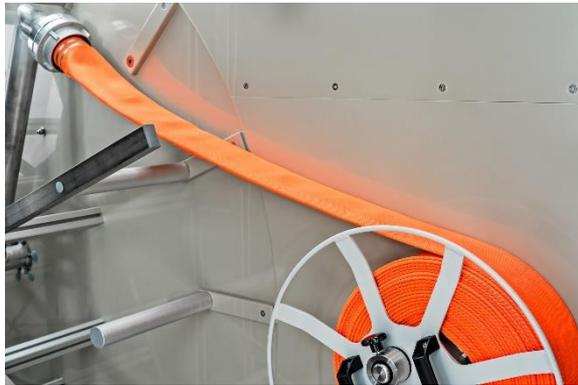
Der am Prüfanschluss angeschlossene Schlauch wird automatisch vom Schlauchwickler herunter auf die Prüfscheibe gezogen und gleichzeitig unter konstantem Wasserdruck gefüllt.
