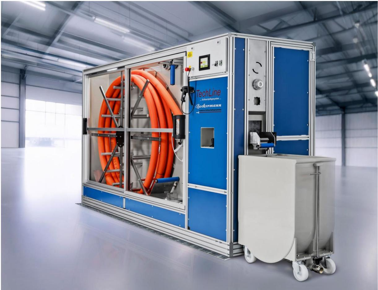
Die Abbildung zeigt eine TechLine Professional Schlauchwaschanlage während der Druckprüfung
