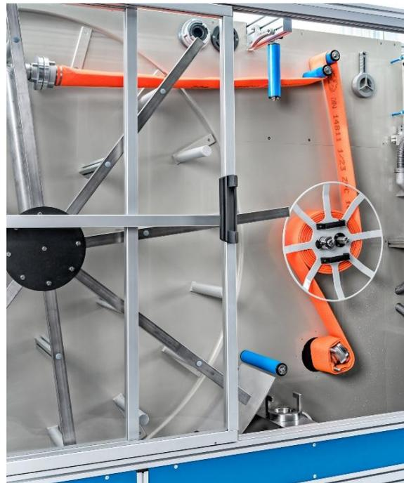
Die fertig aufgerollten Schläuche können in ergonomischer Höhe von den Wickelstiften des Schlauchwicklers heruntergezogen werden.
