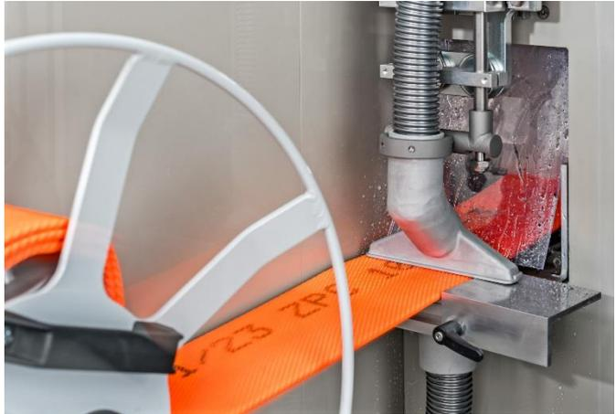
Direkt während der Reinigung erfolgt vollautomatisch die Trocknung der Schläuche mittels effizienter Vakuumtechnik. Über Düsen wird das Waschwasser beidseitig von der Oberfläche des Schlauches abgesaugt. Durch diesen Prozess wird neben der Trocknung eine zusätzliche Reinigung der Schläuche erreicht. Das abgesaugte Wasser wird in einem, in der Anlage integriertem Behälter, aufgefangen und vollautomatisch abgepumpt.
